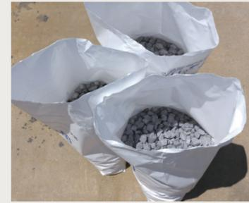
FLASH BAGに20mm骨材を充填し、3段重ねにした状態に散水した状態です。散水後、数秒で袋のパルプ繊維は解け、充填物の骨材が紙を押し破るようにして現れます。
