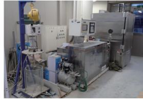
実験室(手前から、すり減り試験機、凍結融解試験機、中性化促進試験機)
